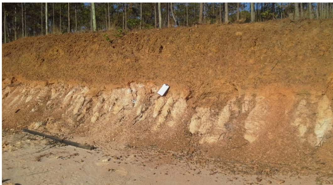
Figura R1 - 01: Corte demonstrando espessa crosta laterítica sobrejacente ao nível mosqueado-saprolítico de composição ferruginosa-caulinítica.
