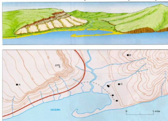
Fig. 01 - Mapa topográfico (abaixo) ilustrando linhas de contorno a partir de um desenho esquemático (acima).
