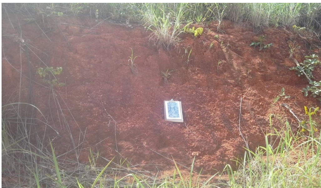
Figura R3 - 27: Perfil em latossolo petroplíntico demonstrando a significativa espessura do horizonte mais endurecido (nível da pajela). Sobradinho/DF.
