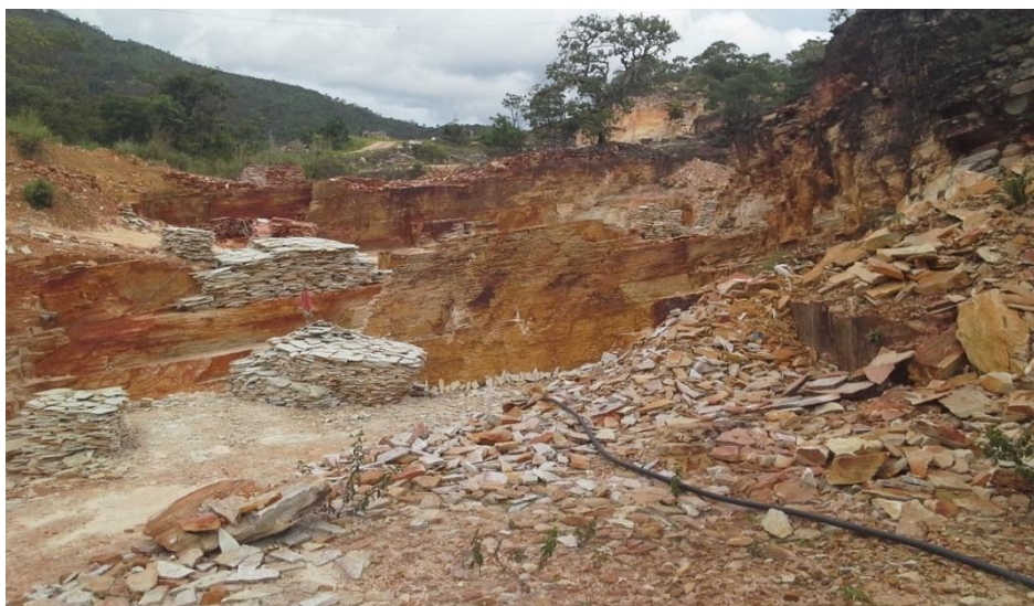
Figura R2 - 06: Frente de lava à céu aberto ilustrando a extração de rochas quartzíticas. Pirenópolis/GO.
